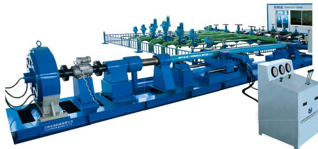
立林螺杆钻具马达试验台和整机试验台是当今钻井工具运行情况模拟的重要平台。试验台可有效同步完成最大扭矩、最小扭矩、压差和流量等参数的检测。通过数据分析,有效评定螺杆钻具马达线形配合,为检验马达质量提供依据。
